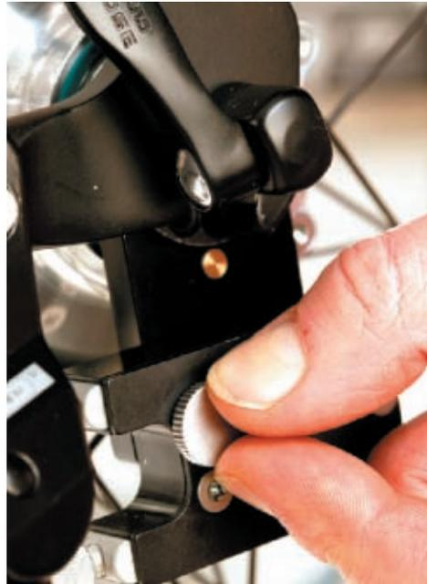
der Leerweg des Drehschalters sich im Laufe der Zeit vergrößert. Diesen Leerweg können Sie reduzieren, indem Sie die beiden Stellschrauben an der Seilbox um den gleichen Betrag weiter herausdrehen.
