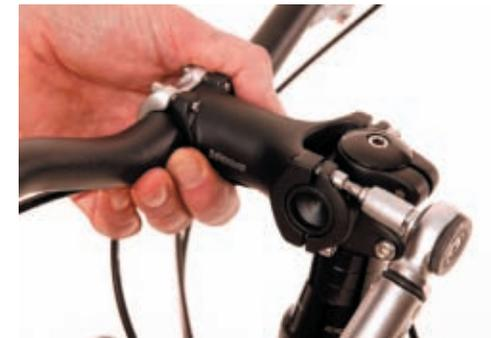
zwischen Klemmschelle und Ausleger oben wie unten auf beiden Seiten gleich groß ist. Von diesem Zustand ausgehend, ziehen Sie die Schrauben in kleinen Schritten abwechselnd an, bis alle ein Anzugsmoment von 6 Nm erreicht haben.
