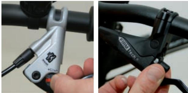
die Beläge näher an die Felge und umgekehrt. Verwenden Sie zu diesem Zweck nicht die 5-mm-Inbusschrauben an den Bremskörpern (s. Foto). Diese dienen lediglich dazu, die Bremsbeläge im gleichen Abstand zur Felge auszurichten.
