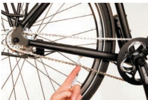
die Kettenspannung je nach Stellung der Zahnräder verändert. Dieses Phänomen ist ganz normal und tritt bei fortlaufender Nutzung noch deutlicher zutage. An der Stelle mit der stärksten Spannung sollte die Kette sich etwa einen Zentimeter nach oben drücken lassen. Wenn der Kettenturm sich deutlich mehr als einen Zentimeter aus seiner Ruhelage nach oben bewegen lässt, sollten Sie die Kette nachspannen. Dadurch verringern Sie die Gefahr, dass die Kette auf schlechter Wegstrecke abspringt.
