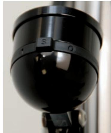
ser Stellung zu belassen. Denn erst bei aktivierter Beleuchtung produziert der Nabendynamo Strom, so dass der durch den Dynamo leicht erhöhte Fahrwiderstand auch dann erst auftritt. Bei Tageslicht fahren Sie bei aktiviertem Sensor genauso leicht wie bei manuell ausgeschalteter Beleuchtung.
