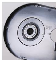
8. Tretlagergehäuse und EBB-Klemmschrauben fetten und danach EBB LL einsetzen.
