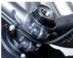
10. O-Ring auf die Kurbelachse aufschieben
