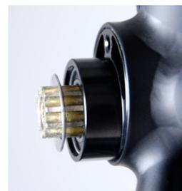
13. Die Kurbelmutter mit mindestens 60 Nm und maximal 70 Nm festziehen.
