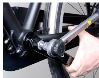
14. Zum Schluss die Kette nach vorhandener Anleitung spannen und die EBB-Schrauben mit mindestens 12 und maximal 15 Nm anziehen.
