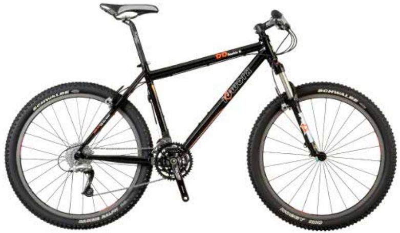
Vorreiter in Sachen Hardtail-Komfort: Das erste Idworx „Double-D“, setzte im Jahr 2000 mit ungewöhnlich flachem 68-Grad-Lenkwinkel und 2.4 Zoll breiten Schlappen ein Ausrufezeichen.
