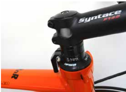
Kleines Teil, große Wirkung: Der Lenkeinschlagsbegrenzer am Steuerrohr der Idworx-Bikes verhindert Schäden an Rahmen und Bremsleitungen.
