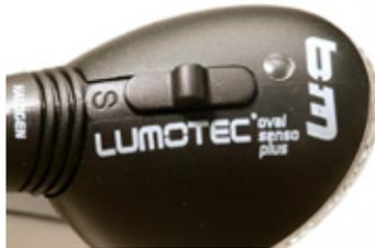
obersten Position zu belassen (unten wird „S“ sichtbar). Dann übernimmt eine Fotodiode die Aufgabe, die Beleuchtung unterhalb einer bestimmten Umgebungshelligkeit ein- und oberhalb selbsttätig auszuschalten. In diesem Betriebsmodus können Sie es nicht versäumen, rechtzeitig bei Einbruch der Dunkelheit oder beim Durchfahren eines Tunnels das Licht einzuschalten.
