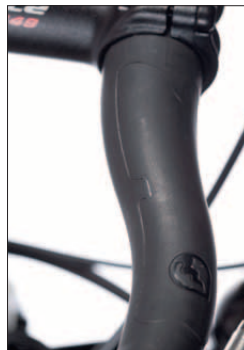
Der Baramind-Lenker birgt eine Trägerplatte und Dämpfer-Einsätze, die abwärts federn, den Rückschlag aber abbremsen können.
