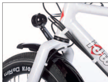
Idworx hat die Gabel neu und extrem lang-lebig konstruiert: Die Krone wird nicht mehr durch eine Bohrung fürs Licht geschwächt.
