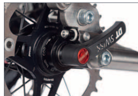
Fast unsichtbar: Eine 10mm-Steckachse versteift den gesamten Hinterbau.
