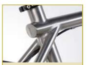
• Oben: Für Steifigkeit: Breit angesetzte Sitzstreben am ovalisierten Oberrohr, das Sitzrohr geht durch • Unten: EBB Exzentertretlager, Longlife-Kettenblatt, Kabelführung alles Speziallösungen
