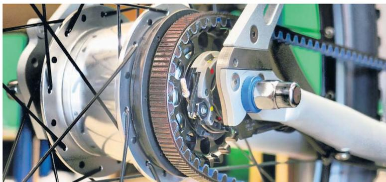
Maßarbeit: Das Velotraum VK7 in unlackiertem Aluminium mit dem Riemen-Antrieb von Gates. Zur Vermessung der präzisen Ausrichtung von Tretlager und Hinterrad werden digitale Wasserwaagen eingesetzt – auf 0,3 Grad genau. Die richtige Spannung des Riemens prüft ein einfaches Gewicht (Mitte links und rechts). Auch nach der korrekten Montage geht es eng zu: Der Riemen ist breiter als eine Kette und sitzt vergleichsweise weit zur Rahmenmitte hin.
