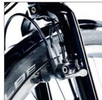
Die Firmtech-Bremsen erfordern präzisen Rahmenbau und sind eine Art Idworx-Markenzeichen.
