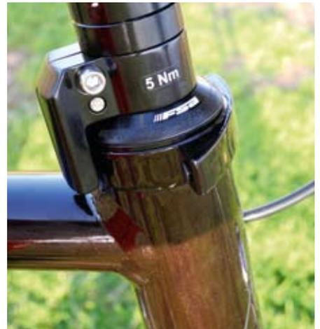
Eingefräst statt montiert. Der Lenkanschlag ist typisch für Easy Rohler-Modelle, natürlich auch bei der Evo-Version.
