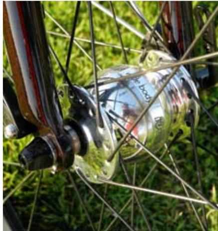
Rund zwei Zentimeter breiter als andere: Der „Wide Body“-Nabendynamo von SON ist eine Sonderanfertigung für Idworx.
