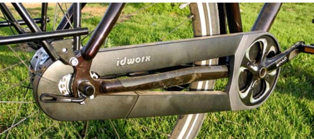
Mit Hessling vor sieben Jahren konzipiert und ständig weiter verbessert: der zweifarbig und komplett geschlossene Idworx-Kettenkasten hat sogar eine Kettenbürste intus.
