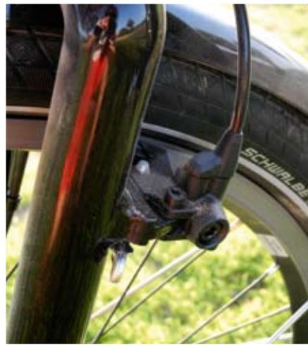
„Auflaufend“ montierte Magura-Hydraulikbremsen in Firmtech-Version: leichter und besser als Standard-Maguras.
