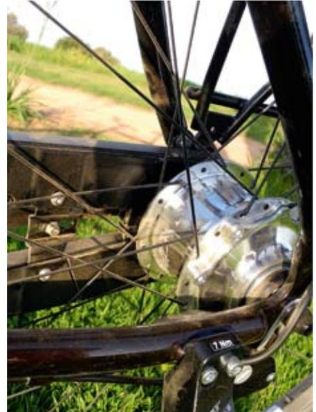
Sitzt fast versteckt im Hinterbau, fällt aber auf: die auf Hochglanz polierte Rohloff-„Speedhub“ Getriebeabdeckung mit 14 Gängen.
