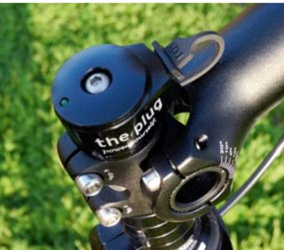
Von Tout Terrain kommt die Strom-Zapfstelle „The Plug“, an der sich ein Mobiltelefon oder Navigationsgerät anschließen lassen.
