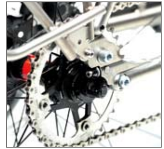
Das kräftige Spezialausfallende und das sehr haltbare Kettenblatt.
