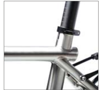
Der typische Sitzrohrknoten versteift den Rahmen effektiv.
