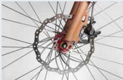
*Best of Reisebremsen 1: Die Brakeforce One H20 am Velotraum nutzt Wasser zur Kraftübertragung. Zusammen mit der 203 mm-Bremsscheibe bingt sie genug Bremskraft für schwere Fuhren. Gut für Ungeübte: Sie packt nicht bissig zu, der Druckpunkt ist eher weich, die Kraft entfaltet sich progressiv.*
