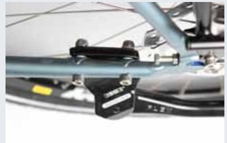
*Dauerhaft fest: robuste Montage des stand-sicheren Pletscher-Hinterbauständer am Poison.*
