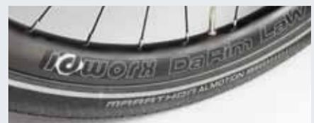
*Felge-Reifen-Optimierung 2: Idworx bietet als Option extraleichte und 32 mm breite DaRim Law-Felgen mit 50er Almotion Tubeless-Reifen an. Das vereint den gefühlten besten Leichtlauf im Test mit Komfort, Fahrdynamik und Pannensicherheit – verlangt allerdings regelmäßige Erneuerung der Dichtmilch.*
