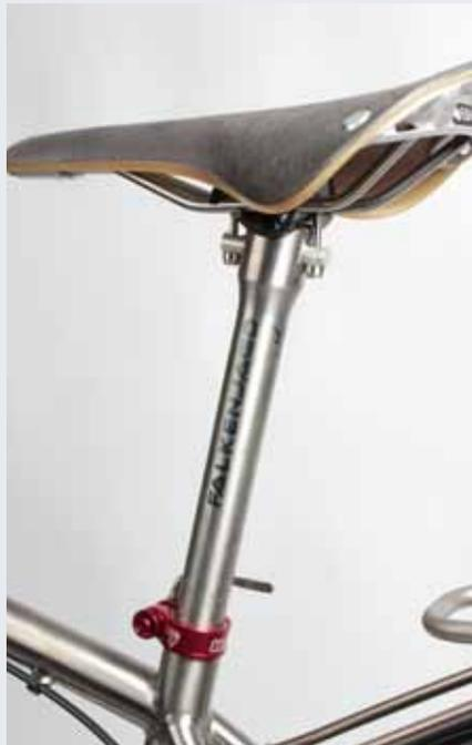
*Edel und gut: Die weit herausgezogene Titan-Stütze und der hängemattenartige Brooks Cambium-Sattel verhelfen dem Falkenjagd zu einer wirksamen aber wartungsarmen Stoßdämpfung hinten.*
