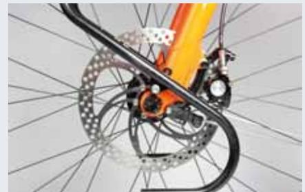
*Best of Reisebremsen 2: Die Hope-Bremse mit extradicken Idworx-Speziialscheiben lässt hervorragendes Wärmemanagement erwarten. Sie besitzt einen harten Druckpunkt, packt kräftig zu und ist sehr fein dosierbar.*
