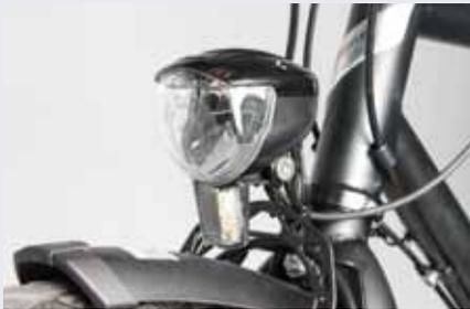
*Laden und weit leuchten: Der B&M Luxus am Fahrradmanufaktur besitzt einen eingebauten Pufferakku und einen USB-Ladeanschluss mit Fernlichttaste am Lenker.*
