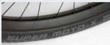
*Felge-Reifen-Optimierung 1: Am Velotraum sitzt der 650B+ Schwalbe Moto-X auf einer 40 mm breiten Felge. Das schöpft die Vorteile der großen Breite konsequent aus: mehr Komfort und höhere Geländegängigkeit. Nachteil: fühlbar schwerere Beschleunigung.*
