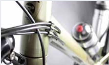
*Schöner Weg: Koga führt alle Züge und Hydraulikleitungen sauber am Rahmen vorbei und in den Rahmen hinein. In das Steuerrohr ist ein Lenkansschlag integriert.*
