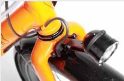
*Kluger Weg: Idworx neue Reiseradgabel ist im Gabelkopf stabiler, der neue Scheinwerferhalter mit zwei seitlichen statt einer zentralen Schraube entlastet die Konstruktion – und bietet eine saubere Führung für das Lichtkabel.*
