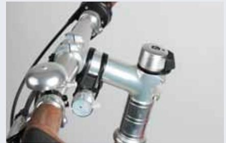
*Nur laden: Der Plug III sitzt unauffällig im Steuerrohr und lädt dort über USB das Smartphone & Co – die Wahl der meisten Hersteller. Rotor (Bild) platziert die passende Powerbank von Cinq geschickt am Vorbau.*
