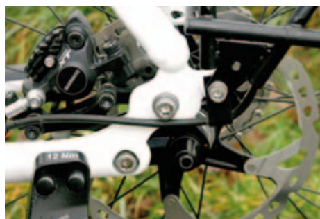
Das Herzstück des neuen oPinion: Spezial-Ausfall-Ende, das narrensichere und einfache Kettenspannung erlaubt.
