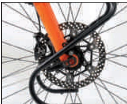
Hope Bremsanlage mit verstärkter Idworx-Bremsscheibe
