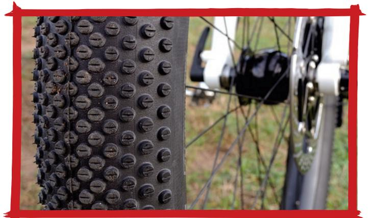
Der fast 70 Millimeter breite G-One von Schwalbe rollt leicht, macht aber fast jeden Dreck mit – erst bei Schlamm hört's auf.
