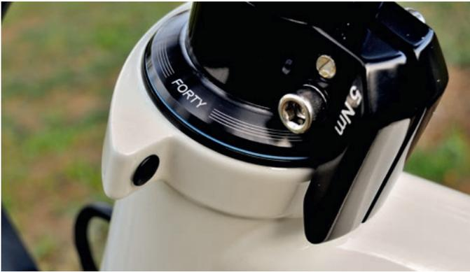
Äußerst effizient: Der rahmenintegrierte Lenkanschlag verhindert, dass der Lenker beim Sturz oder Umfallen des Rads auf den Rahmen schlägt.
