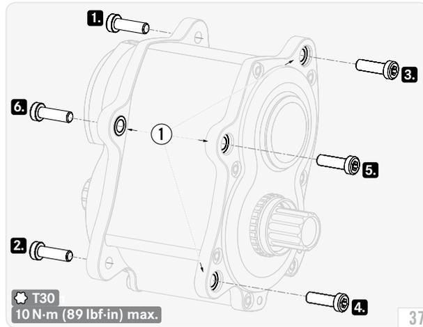
**ⓘ INFO** Getriebehalteschrauben dürfen – gereinigt und mit frischer Schraubensicherung (mittelfest) versehen – wiederverwendet werden.
