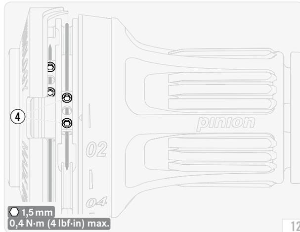
**① INFO** Die Klemmschrauben sind gut zugänglich in den Schaltgriffpositionen **01** und **18** bzw. **01** und **12** bzw. **01** und **09** abhängig vom Typ Ihres Pinion Getriebes.
