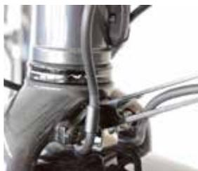
*Gut gelöst: Der Scheinwerferhalter ist an zwei Punkten mit dem Gabelkopf verschraubt und führt die Lichtkabel.*
