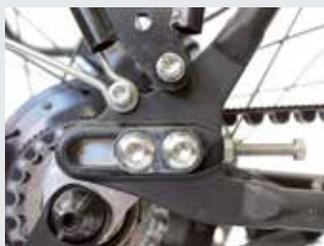
Am Poisson wird der Riemen über ein verschiebbares Ausfallende gespannt und mit einer Stell-schraube feinjustiert.
