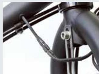
Die ungeschützte Steckverbindung am Poison ist anfällig und könnte unterwegs das Licht ausknipsen.
