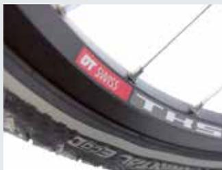
Doppelt geöst und beschichtet: die robuste 19 mm Trekking Felge passt zum schmalen Conti-Reifen.
