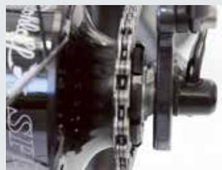
Dank Exzenter kann bei Idworx und Tout Terrain die Achse ohne Zwischenstück direkt aufgenommen werden.
