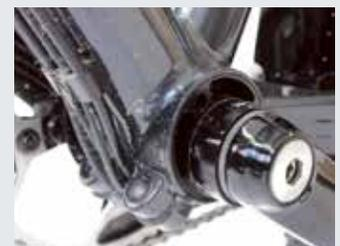
Um Kette oder Riemen zu spannen, müssen die zwei Klemmschrauben gelöst werden. Das Lager lässt sich dann samt Achse im Gehäuse drehen, um Spannung aufzubauen. ►
