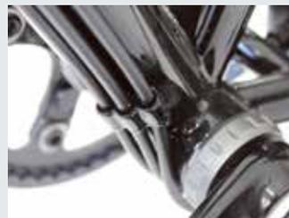
Gut geführt: Rennstahl spendiert dem Rahmen eine integrierte Zugführung.
