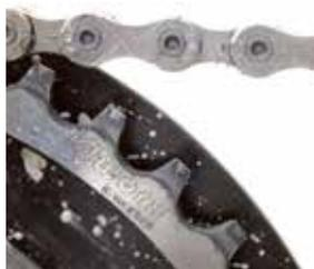
*Was dem hohen Anspruch nicht genügt wird selbst gemacht, wie das verschleißarme Kettenblatt aus Messerstahl.*
