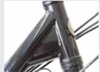
Steif trotz tiefem Einstieg: Rennstahl setzt voluminöse Rohre und Verstärkungen ein.
