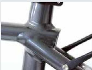
Extra steif: Bei Idworx durchstößt das Sattelrohr das Oberrohr.
