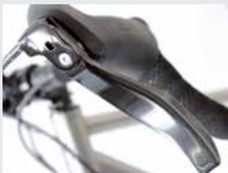
Die neue Shift:R Road am Hilite ermöglicht das Schalten der Rohloff vom Rennlenker bei integrierter hydraulischer Bremse.
