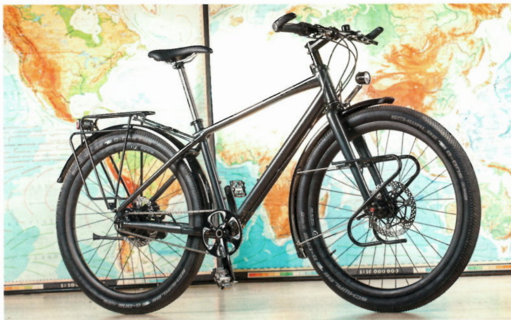
Die Big Disc trägt ihren Namen zu Recht: Sie ist 3,2 Millimeter dick und verträgt deshalb extrem hohe Brems Temperaturen
