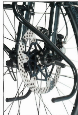
Die Big Disc trägt ihren Namen zu Recht: Sie ist 3,2 Millimeter dick und verträgt deshalb extrem hohe Brems Temperaturen
