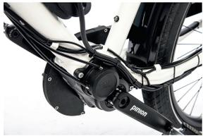
Pinion Tretlagergetriebe C1.6 mit 295% Übersetzungsumfang.
