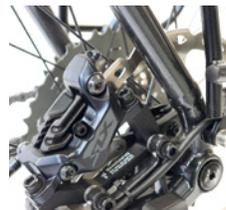
Die SLX presst mit vier Kolben im Sattel auf die Scheibe: beste Bremse im Test!
