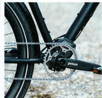
Ritzel/Kettenblatt wechselseitig tauschbar = kürzere Übersetzung.
