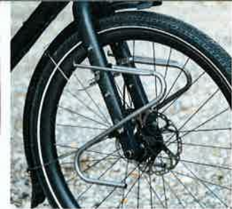
110 mm breite Carbongabel und mittig gespeichtes Vorderrad.
